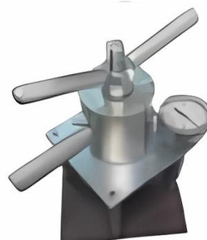
TESTMAX25K TESTER PARA PUNTOS DE ANCLAJE 25KN
